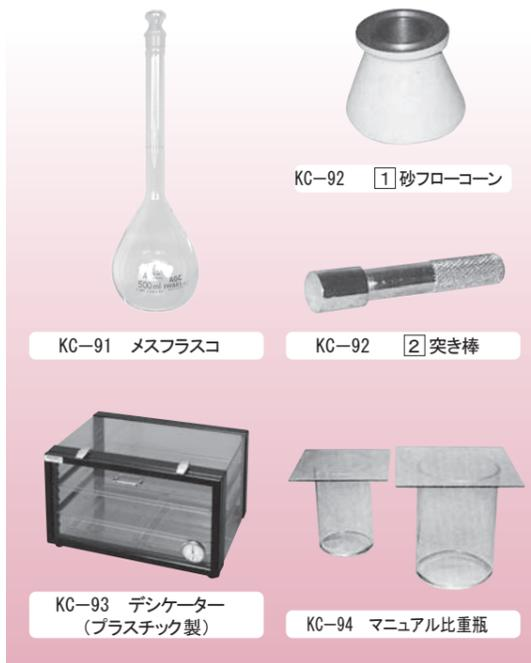
粗骨材(人工軽量骨材は除く)の密度及び吸水率の試験装置です。
