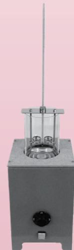
KA-5 [A] 軟化点試験器電気式
