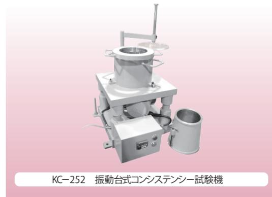
KC-252 振動台式コンシステンシー試験機
