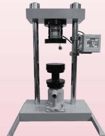
KC-363-B 能力100kN簡易圧縮試験機
