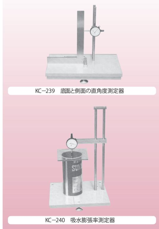
KC-239 底面と側面の直角度測定器
