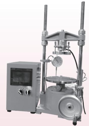
KS-205 [C] デジタル表示式一軸圧縮試験機(自動式)
