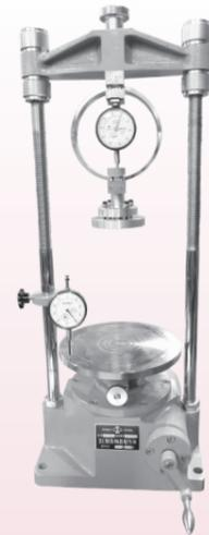
KS-77 手動式一軸圧縮試験機
