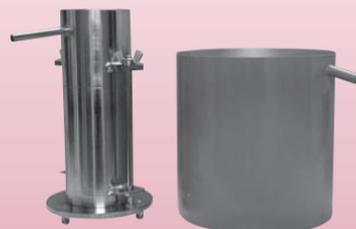
KC-359 ポラスコンクリートの透水試験装置
