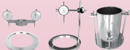
③ 貫入量測定装置 ④ 膨張量測定装置 ⑤ 15cmモールド
