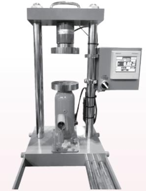
KC-363-A 能力40kN簡易圧縮試験機
