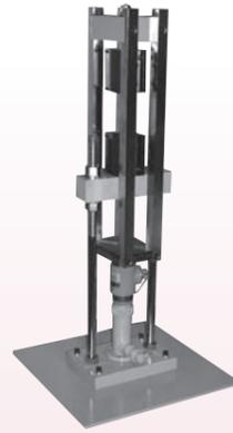
KC-365 能力50kN引張試験装置
