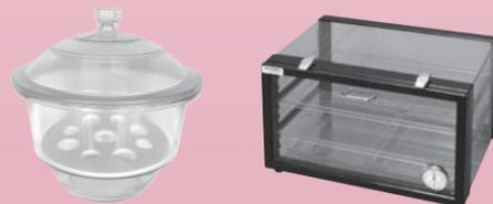
KS-8 デシケーター(ガラス製 並置) KS-9 デシケーター(プラスチック製)
