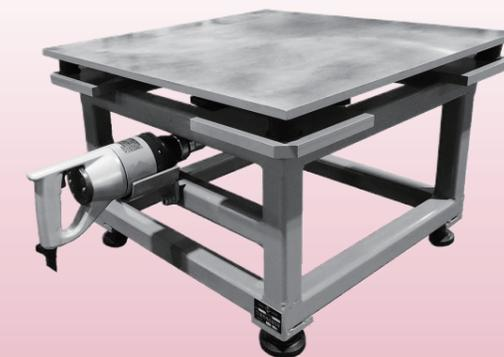
KC-370 加振変形試験機 NEXCO型
