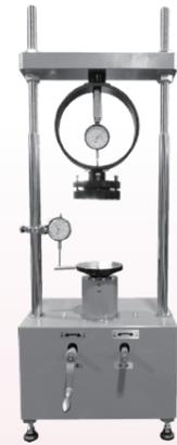
KS-217 スクリージャッキ式一軸圧縮試験機
