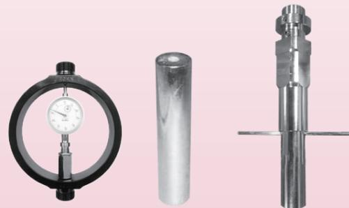
① 荷重計 ②a 貫入ピストン ②b アジャスト式貫入ピストン
