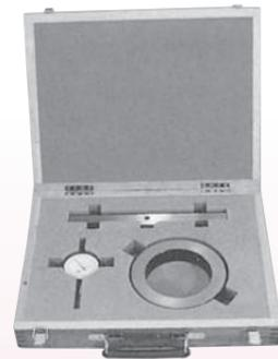
KC-201 平面度検査器(圧縮型枠用)
