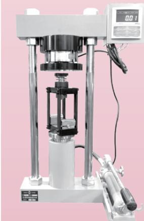
KC-23 手動式デジタル型モルタル圧縮試験機
