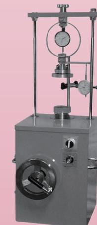
KS-216 電動・手動兼用型土の一軸圧縮試験機 5000N
