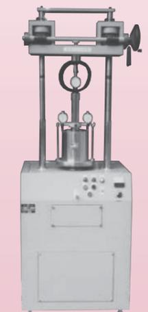
KS-60 CBR試験2本柱式載荷装置(力計別売り)
