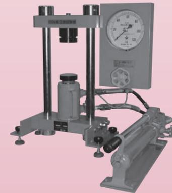
KC-364 能力100kN手動式圧縮試験機
